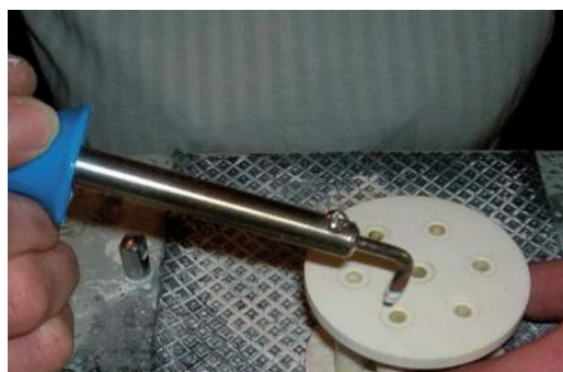
Manuelles Verschweißen der Einzelkomponenten
